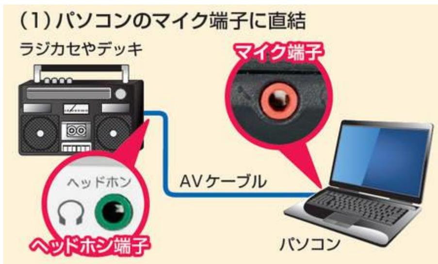
パソコンのマイク端子に直結する方法。AV ケーブルとフリーの音楽取り込みソフトを使えば、安上がりにデジタル化できる。ただし、パソコンによっては、電子回路のノイズを拾い音質が悪くなることもある
