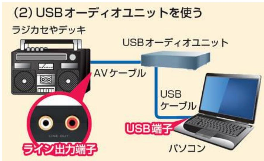
音声取り込みの専用機器を使う方式。取り込み用のソフトも付属する。パソコンの電子回路のノイズの影響を受けないのがメリット。機器は安価なものから本格的なものまで、幅広い
