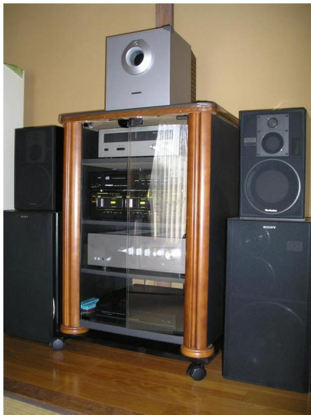
▼上記写真・今回制作したステレオ装置。オーディオボードの上はアイワのスーパーウーファー。オーディオボード内上端から FM・AM チューナー、CD プレーヤー、W カセット・プレーヤー、新たに購入した YAMAHA メインアンプ、最下段はレコード・プレーヤーとなっている。周囲のスペースに余裕があればスピーカー類は床に直置きし、レコード・プレーヤーはボード上に置けば使い勝手良かった。
